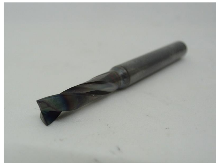
先端5mmフラットドリルの再研磨
