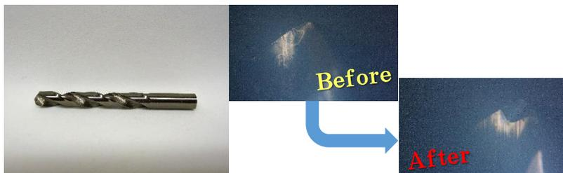
こちらは当社で手掛けた、スパイラルドリルの再研磨事例です。φ4.5mmの超硬材スパイラルドリルです。穴加工を行う為のドリルで非常に一般的な工具となります。本事例は再研磨を行ったのみの事例ですが、ご依頼いただく際、お客様の製品・ワークをお聞かせいただき、ご要望を頂けましたら、先端の角度を調整し、工具の長寿命化・加工するワークの品質向上も提案可能です。
