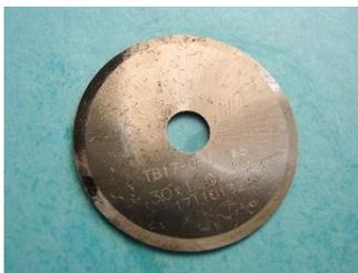
特注工具の製作も行っている 当社による丸刃カッターの製作事例を紹介します。超硬製の厚さ0.5mmの丸刃カッターで、市販はされていない厚みのカッターです。全周が刃になっているため、均一に薄く加工しなければワークの加工精度にばらつきが発生してしまうため、カッター自体の精度出しが重要になります。
