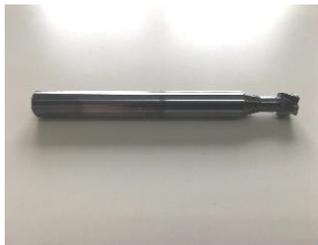
こちらの工具は、当社で製作を行った特注工具の一つで、特殊TスロットカッターにR面をつけた特殊形状となっています。使用用途は、冷間鍛造部品に対するT溝加工(端面R付き)で使用されます。この工具を用いることで、T溝の角部にRを一発でつけることができ、工程削減に貢献しています。この提案は、焼結金属などを切削加工・量産加工を行う再研磨.comならではの提案といえます。
