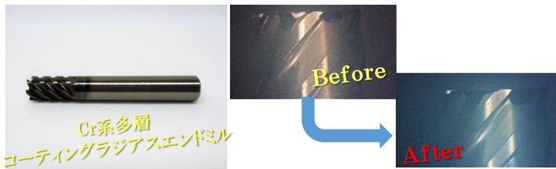
こちらは当社で手掛けた、金型の加工を行う為の強ねじれラジラスエンドミルの再研磨事例の一つです。金型メーカーの方よりお問合せをいただき、手掛けた再研磨事例で、1、カット 2、底刃 3、コーナーR0.2と再研磨箇所が非常に多い事例となります。研磨後、Cr系多層(OSG規格 WD I 相当)コーティングを行いました。※ラジラスエンドミルとは、底刃のコーナーを丸く仕立ててあるのが特徴のエンドミルで、この工具を使うと、刃の角が丸みを帯びたような形状であるので、比較的滑らかな形状に加工できます。
