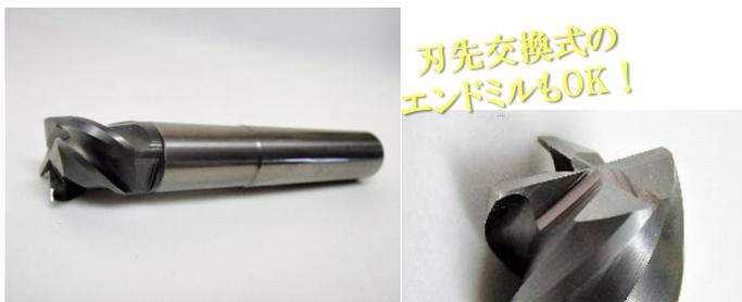
こちらは、当社にて行った刃先交換式のエンドミルの再研磨事例です。当社にて、シャンクをお客様よりお預かりし、定期的に再研磨を行っている製品となります。(刃先交換式のメリットは一般的な工具と比較して、コストが抑えられる点と工具の取り換え工数の削減ができる点にメリットがあると言われていました。)この刃先交換式の再研磨は千円弱で可能となる為、刃先交換式の先端を購入するよりも圧倒的に安く、再利用が可能となります。工具のコストダウンを検討されている方はぜひ。
