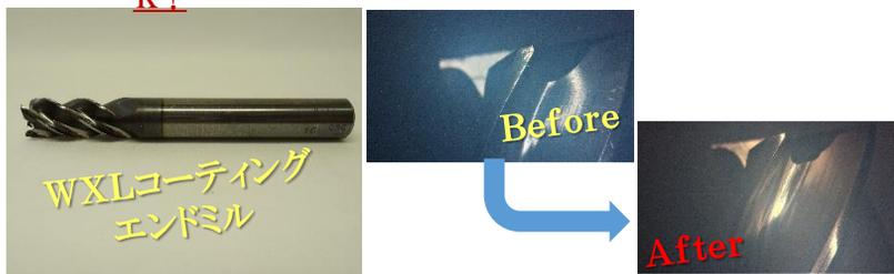
こちらは当社で手掛けた、金型の加工を行う為の強ねじれエンドミルの再研磨事例の一つです。金型メーカーの方よりお問合せをいただき、手掛けた再研磨事例で、1、底刃 2、外周刃 3、刃裏と再研磨箇所が非常に多い事例となります。材質に超硬を使用した国内メーカーの工具である為、新品を購入すると1万円超となってしまいます。そこで当社で、再研磨を行い、かつCr系コーティング(OSG規格 WXL相当)も施すことで新品同様の工具を数千円で提供しています。
